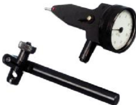
Рисунок 2 - Общий вид индикатора рычажно-зубчатые ИРТ с ценой деления 0,01 мм
