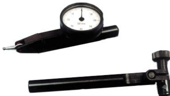
Рисунок 1 - Общий вид индикатора рычажно-зубчатые ИРБ с ценой деления 0,01 мм
